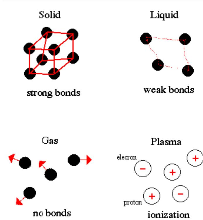
Promjena stanja tvari iz jednog u drugo naziva se promjena faze. Primjer: led (čvrsta voda) prelazi u tekuću vodu dodavanjem energije. Nastavimo li dodavati energiju i voda uzavre prelazi u plinovito stanje (plinovita voda) zatim na nekoliko milijuna stupnjeva dolazi do raspada na komponente – atome.
